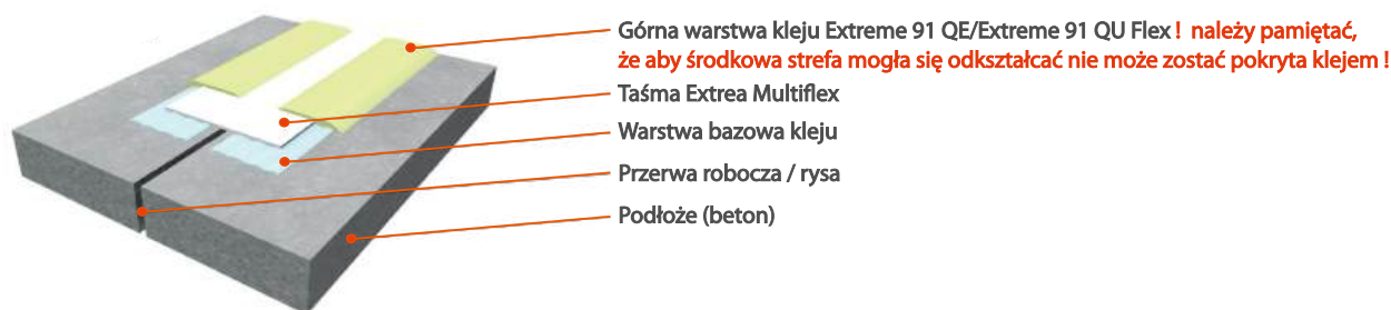
Dylatacja o niewielkich przemieszczeniach
