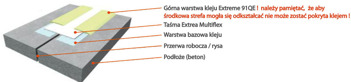
Dylatacja o niewielkich przemieszczeniach
